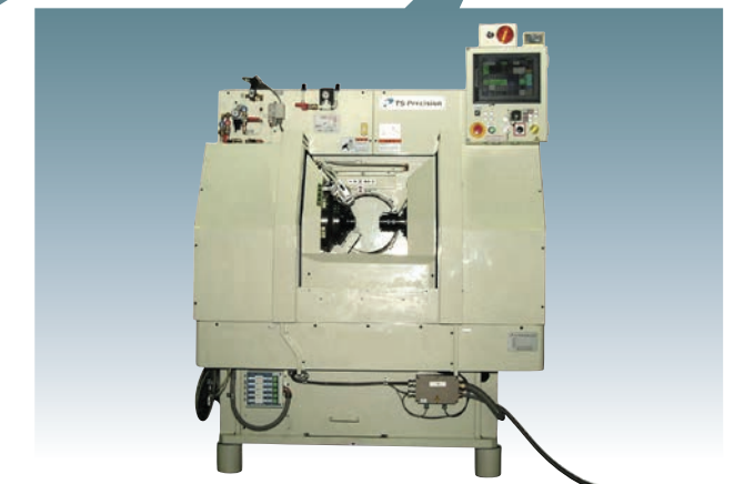
■ケージ窓加工機 Cage Window Milling Machine
